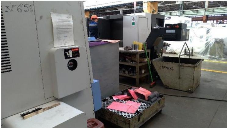
При картировании процесса производства выявлена проблема отсутствия мест временного хранения заготовок перед токарной, фрезерной операцией. Тара занимает 80% полезной площади вокруг станков с ЧПУ.
